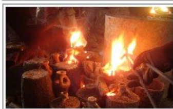
Pouring Molten Metal
